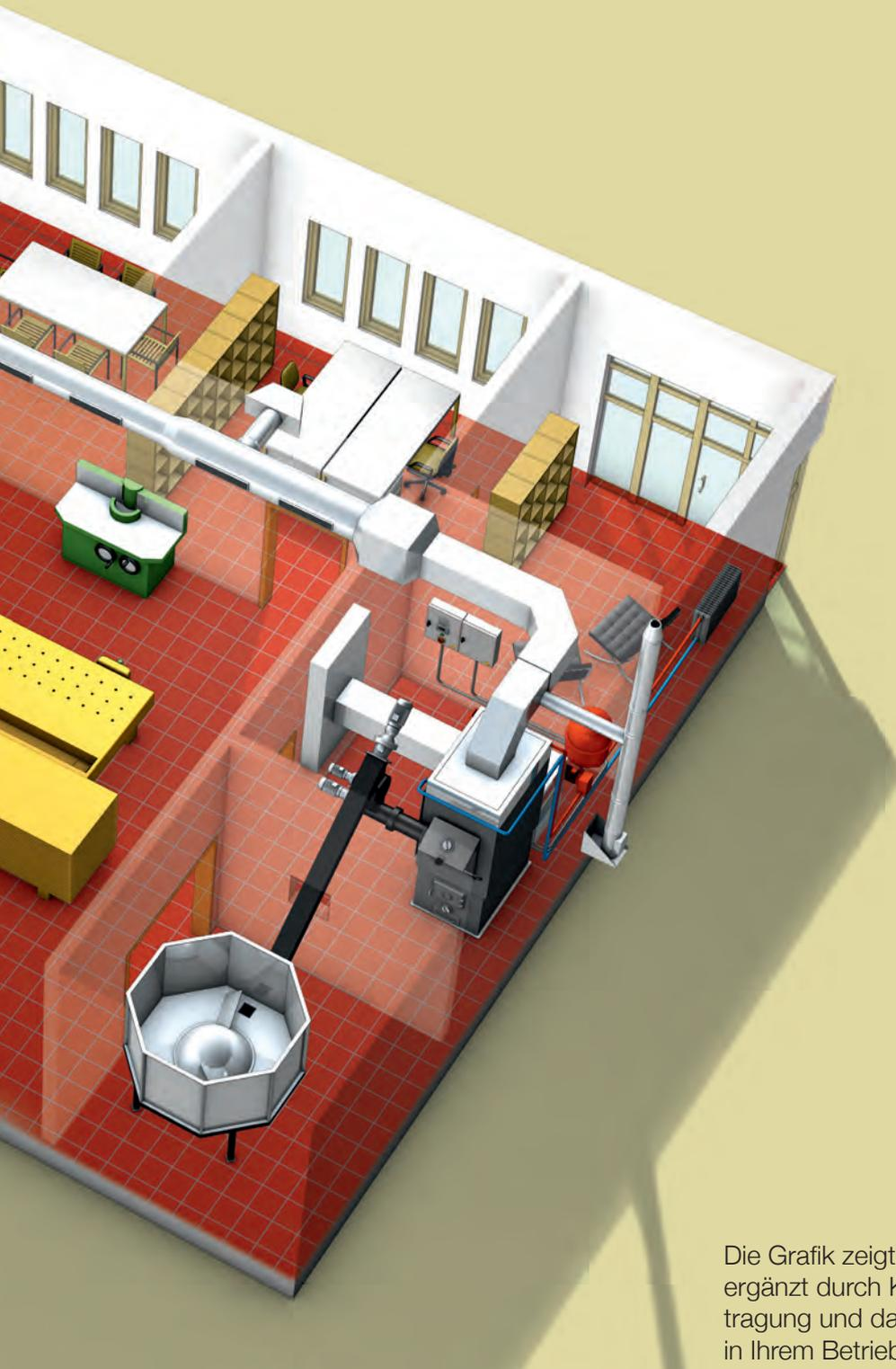
Die Grafik zeigt eine EWI-THERM Warmluftheizung, ergänzt durch Komponenten wie z. B. die Siloaustragung und das Warmwassermodul, wie sie auch in Ihrem Betrieb zum Einsatz kommen könnte.
